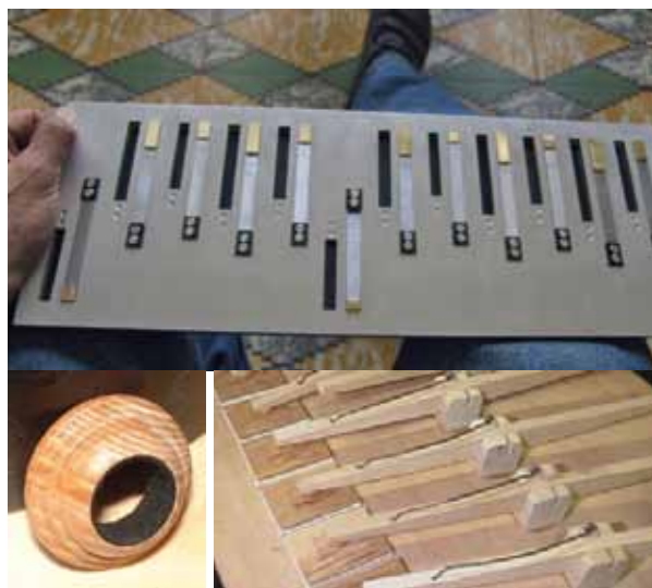
Stimmplatten, gedrechselte Rosetten und Mechanik
